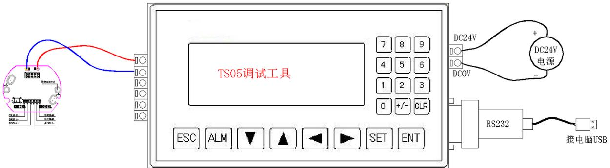
板卡与调试器之间只有 2 根线，本板卡采用的是 EHART 载波通信调试方式，无需任何多余的调试线。
